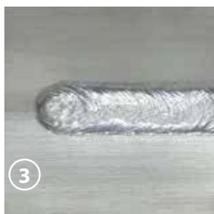
**LIVELLO 3:** una corrente ridotta termina la saldatura in modo ottimale riempiendo il cratere finale sul cordone.
