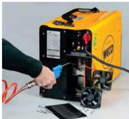
Griglie di ventilazione anteriore, posteriore e ventilatori rimovibili, consentono una facile pulizia dei dissipatori di calore, attraverso il soffaggio con aria compressa.
